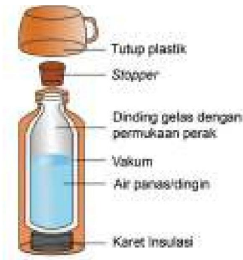
Gambar 6.21. Bagian-bagian termos sumber : Alvius Tinambunan/Kemendikbudristek (2022)
